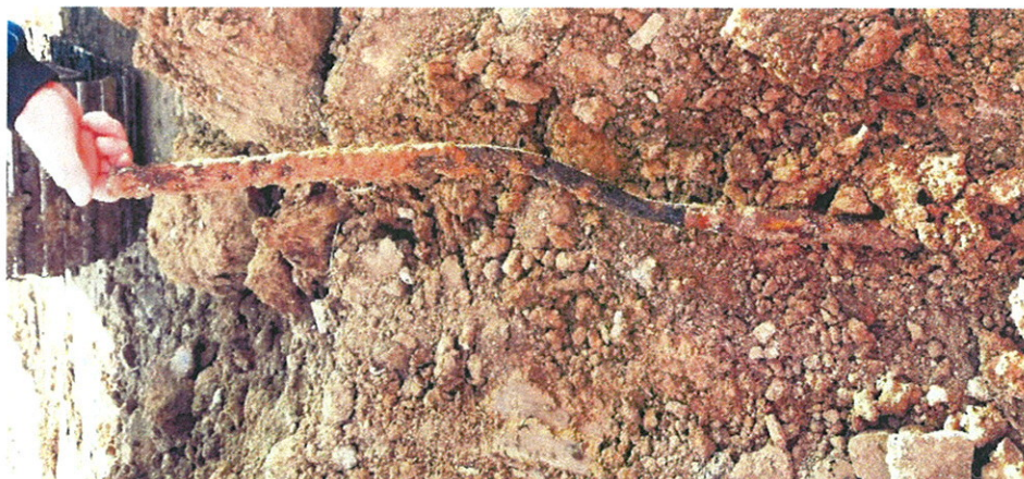
Obr.8 Při prověrce signálu č.2 bylo zjištěno, že jeho zdrojem je mělce uložená ocelová tyč dlouhá cca 1m.
