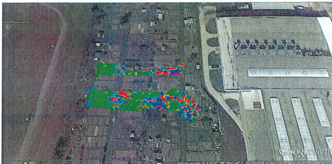
Obr. 7 Výsledek magnetometrie exportovaný do satelitního snímku Google.
