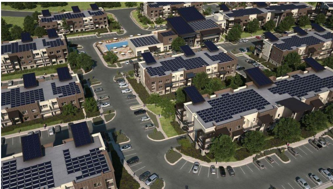
Obr. 4: Ilustrační zobrazení využití FVE na nové zástavbě. Příklad projektu z předměstí Salt Lake City, ze státu Utah, USA. Jde o 600 bytových jednotek, instalovaný výkon 5 MWp. Ekologické a cenově dostupné bydlení. Plocha střech u výstavby realizované RD je násobně vyšší než u BD a má tedy násobně vyšší potenciál pro výrobu energie FVE. Zdroj: pveurope.eu
